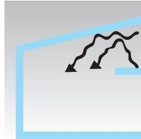
Se coloca horizontalmente por encima del nivel de los ojos, en un elemento vertical de entrada de luz. Protege las zonas interiores próximas a las ventanas contra la radiación solar directa y dirige la luz que incide sobre la superficie superior al techo interior. Proporciona así sombra en verano y hace la distribución luminosa interior más uniforme.
