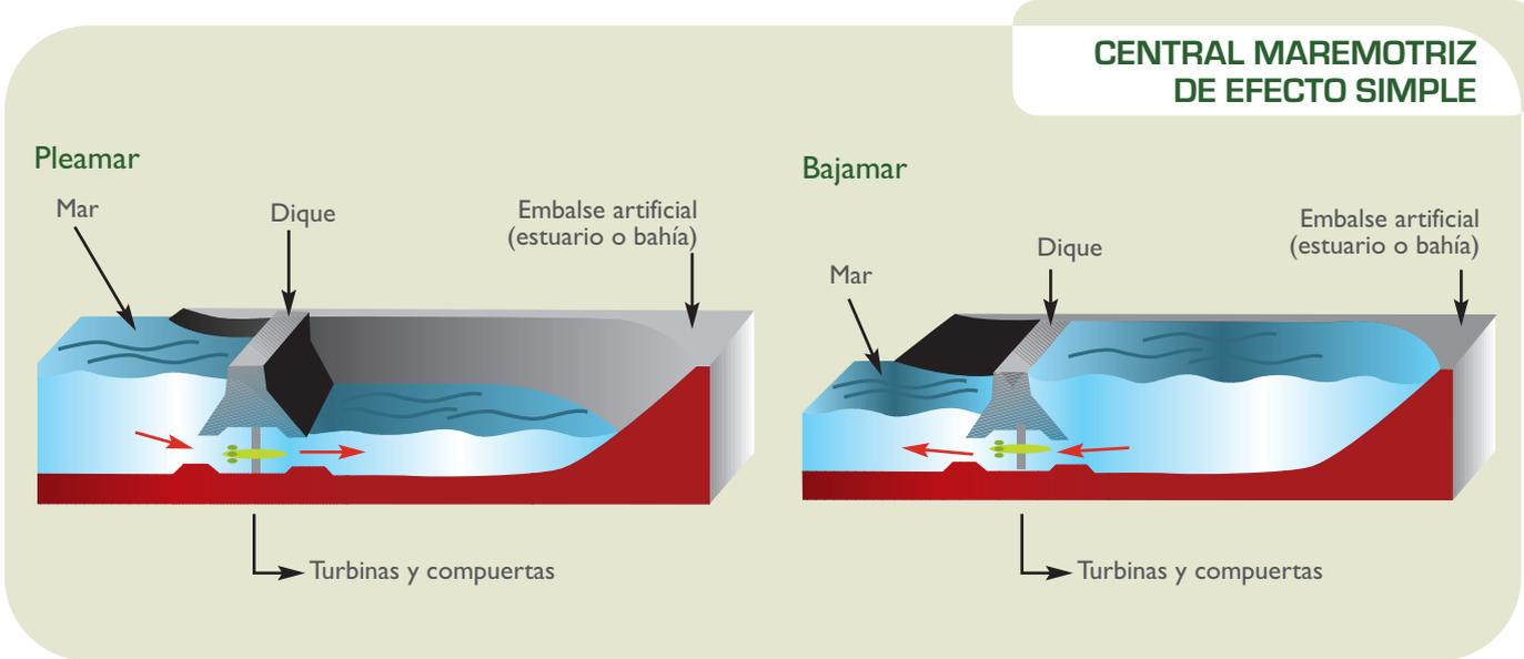
compuertas se abren dando paso a un salto de agua que hace girar una turbina que, a su vez, pone en marcha un generador eléctrico.
