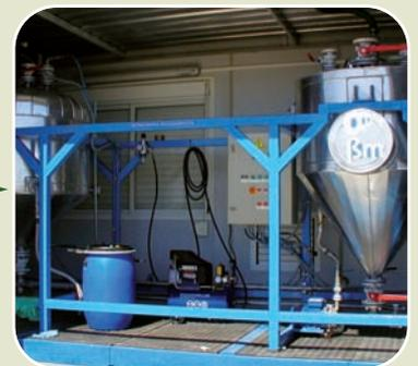
Planta piloto de producción de biodiésel en el ITC (Pozo Izquierdo)
