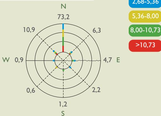
Rosa de los vientos: frecuencia con la que sopla el viento en una dirección determinada y sus velocidades medias
