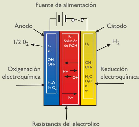
**FUNCIONAMIENTO DE LA PILA DE COMBUSTIBLE**
